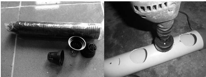
Gambar 29. Net pot dan proses pelubangan pipa dengan hole saw
