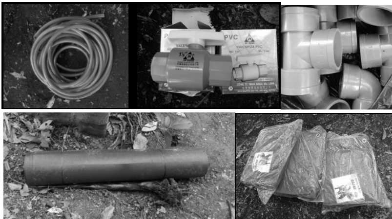
Gambar 19. Bahan pelengkap kerangka kolam bundar : selang air, stop kran, sambungan pipa, karet talang, terpal bulat.
